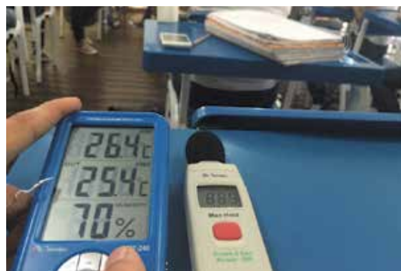
Figura 10 - Equipamentos utilizados na medição da temperatura, umidade relativa e ruído.
